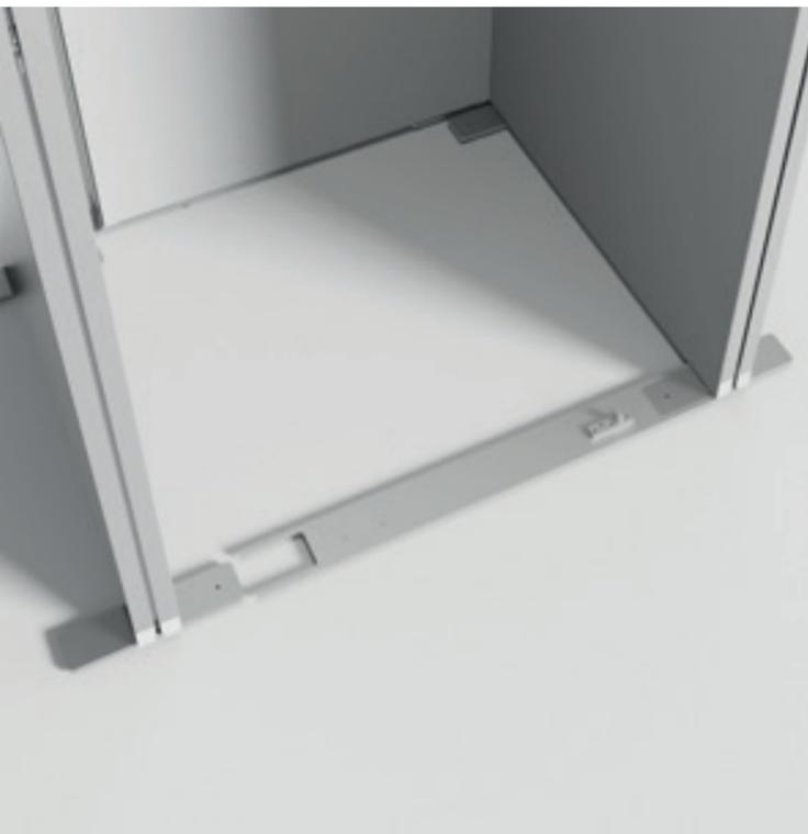
Türschwelle in die ausgeklappten Fußplatten einlegen
