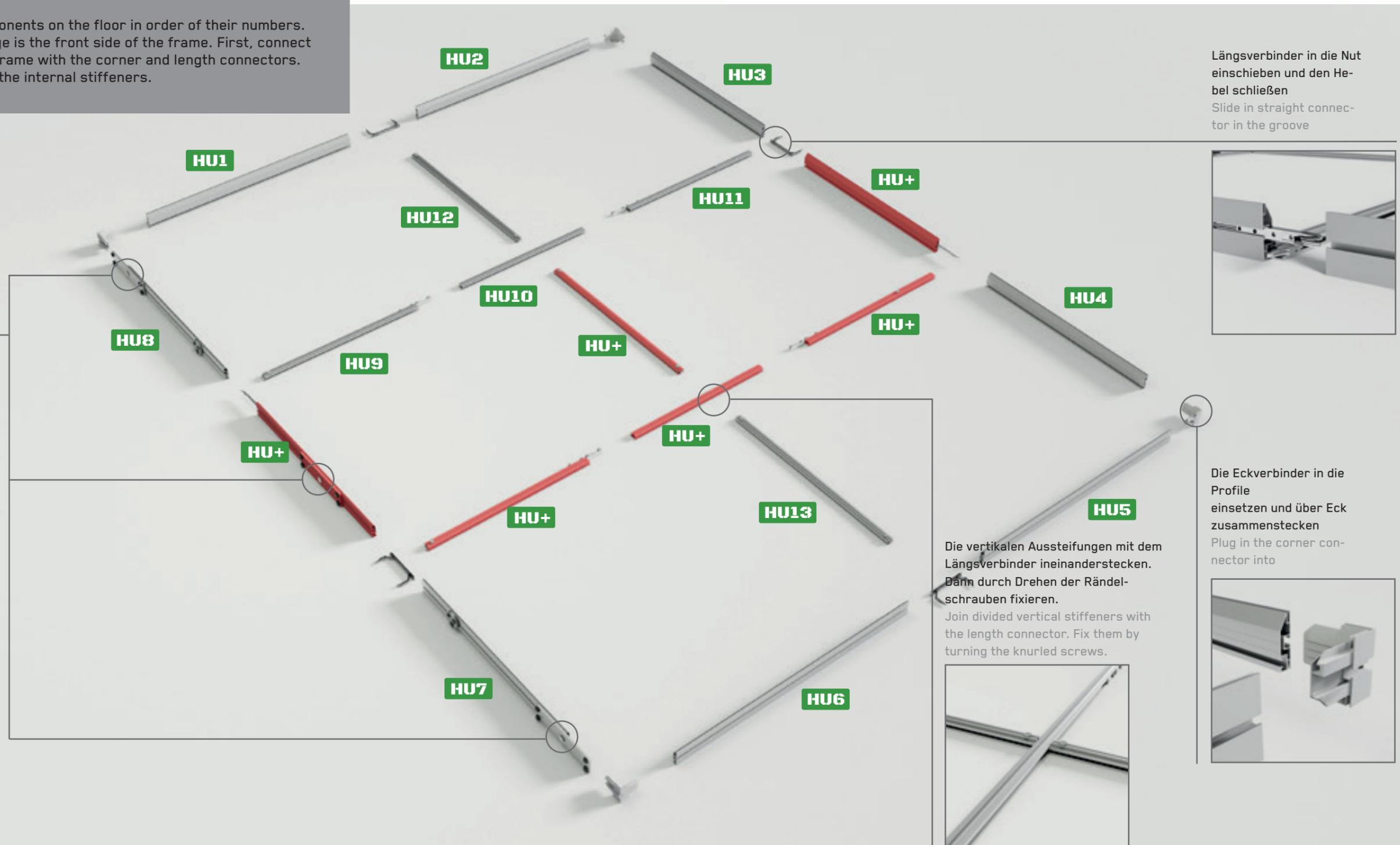
Längsverbinder in die Nut einschieben und den Hebel schließen
