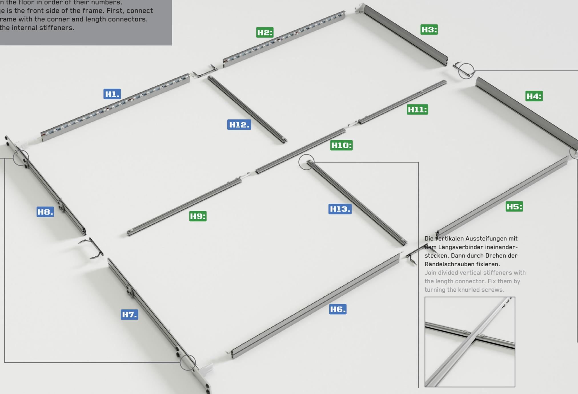
Längsverbinder in die Nut einschieben und den Hebel schließen
