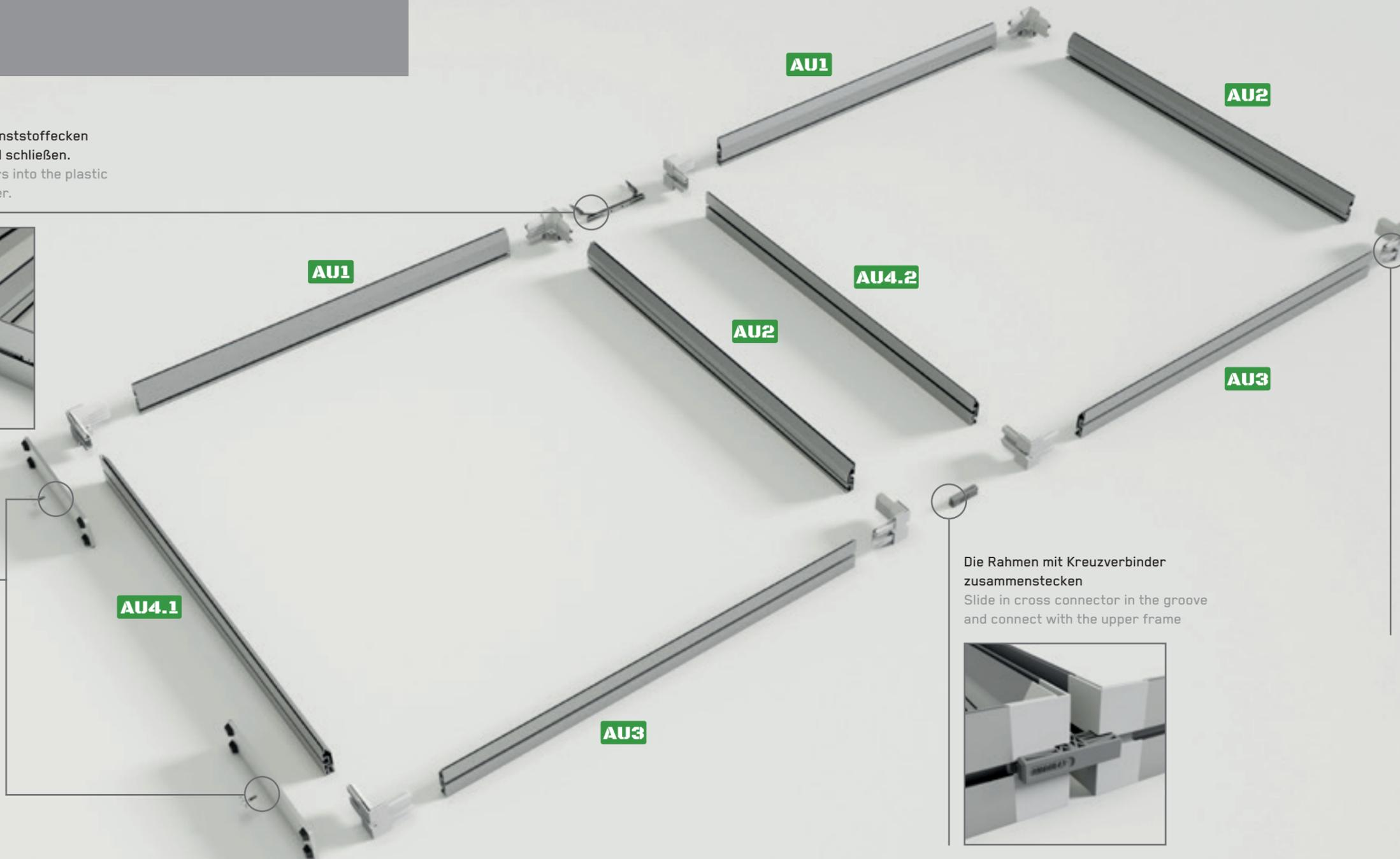
Die Eckverbinder in die Profile einsetzen und über Eck zusammenstecken
