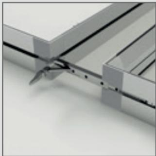
Fußplatte mit der Randschraube am Rahmen AU4.1 mit Nutstein befestigen und um 90° drehen
